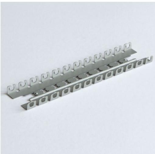
Frei fallende Präzisionsteile mit Toleranzen < 0,02 mm.
