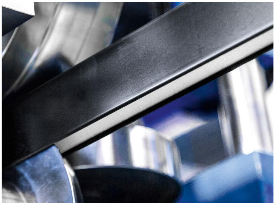
Spezialprofil für die Automobilindustrie aus vorlackiertem Bandstahl.
