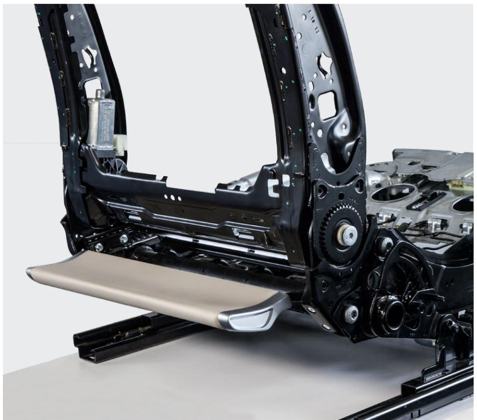
Die elektrisch verstellbare Fersenstütze basiert auf einer Schock Linearführung mit rollgeformten Präzisionsprofilen. Integrierte Schnittstellen zur Anbindung an die Sitzstruktur und die Antriebseinheit vereinfachen die Montage und reduzieren die Teilvielfalt. Mit ihrem kompakten Aufbau hält sie dank intelligenter Formgebung dennoch extremen Belastungen stand.
